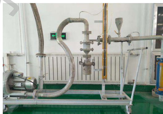
图1 球柱形旋风除尘器实验现场图
