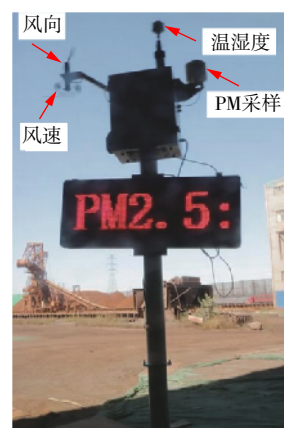
图 3 现场监测的物联网系统
